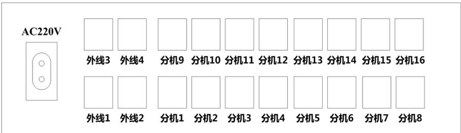
图 3-1. 交换机接口示意图（P 型、D 型）
